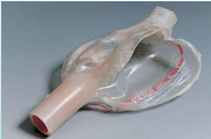
Überhitzung PE-Xa (ohne Alu) unter Druckbeanspruchung Foto: Karl-Josef Heinemann [3]
