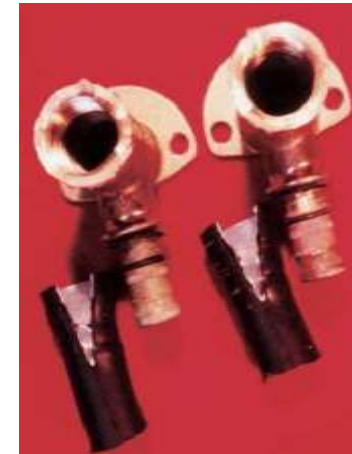
Mehrschicht-Verbundrohr und Wandwinkel, Foto: Karl-Josef Heinemann [3]
