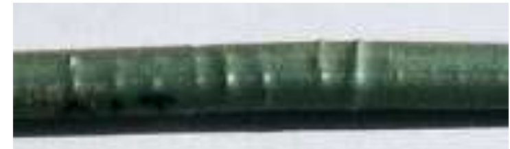
PP-R Alu-Verbundrohr mit Schrumpf außen nach langer Temperaturwechselbelastung Foto: Karl-Josef Heinemann [3]
