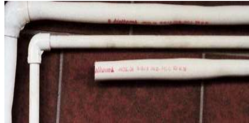
Überhitzung PVC-C (ohne Alu) durch defekten Temperaturregler Foto: Karl-Josef Heinemann [3]
