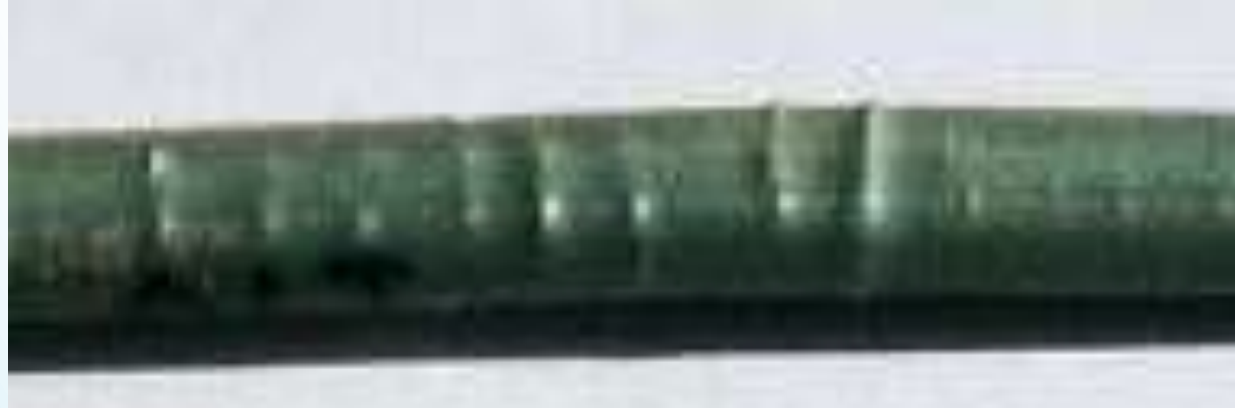
PP-R Alu-Verbundrohr mit Schrumpfung außen nach langer Temperaturwechselbelastung Foto: Karl-Josef Heinemann [3]
