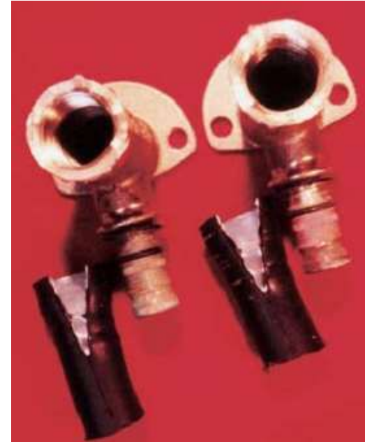
Mehrschicht-Verbundrohr und Wandwinkel, Foto: Karl-Josef Heinemann [3]
